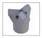
bit di perforazione per rocce DURE specifico per Geosystem minipalo tecnology® barra tipo R38 in acciaio con bit a bottoni al Widia da utilizzare in rocce Dure con resistenze maggiore di 70 MPa e diametro di perforazione pari a 76 millimetri.
